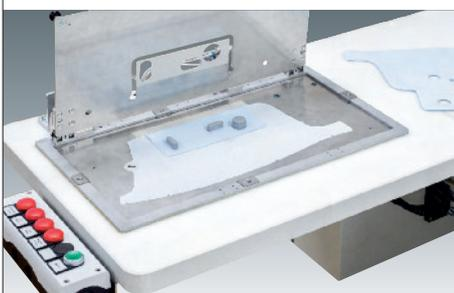
Speziell für das Nähen von Airbags werden kundenspezifische Beistelltische mit „POKA YOKE Systemen“ an der 911-210-10 eingesetzt, die eine hohe Produktivität und Sicherheit durch Überwachung des Fertigungsprozesses ermöglichen.
