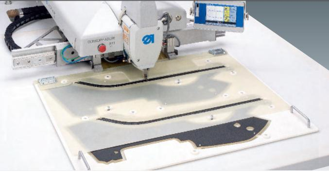
Das Wechselklammersystem ermöglicht eine teil- oder voll-überlappende Arbeitsweise, wodurch eine hohe Maschinen-auslastung und hohe Teileausbringung erzielt wird. Die Wechselklammer eignet sich besonders gut für das Nähen von Zier- und Verbindungsnähten.
