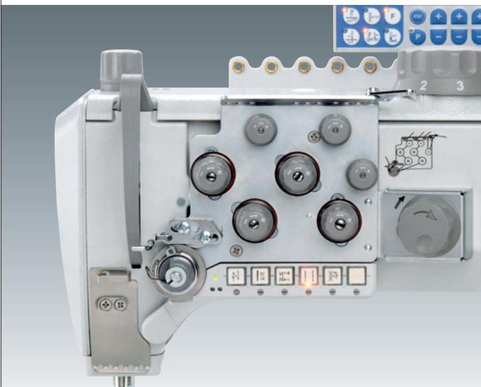
**Elektronisches Handrad** – Besonders ergonomisch gestaltet sich das Arbeiten an der Langarmmaschine durch das elektronische Handrad. Im direkten Griffbereich ermöglicht es die genaue Nadelpositionierung zum präzisen Arbeiten.
