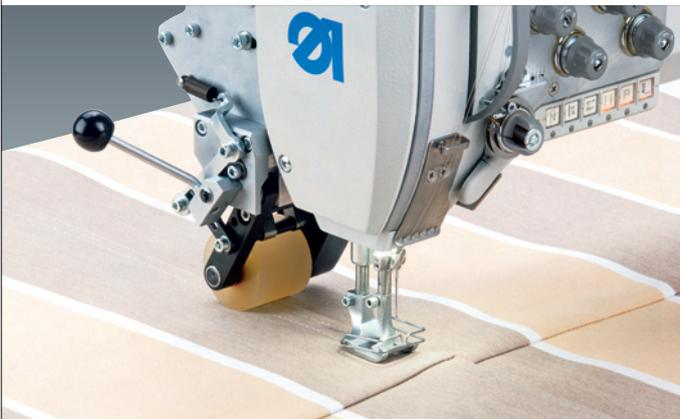
**Optionaler Puller Antrieb** – Elektronisch angetriebener Puller (0867 591144) mit oberer und unterer Walze sorgt für einen einwandfreien Materialtransport mit bis zu 15 mm Vorschub pro Stich bei transportkritischem und großflächigem Nähgut.
