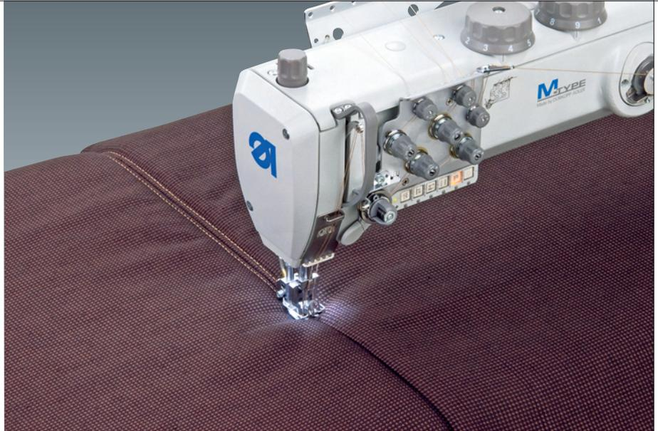
**867-290342-70-M** CLASSIC Goldline mit asymmetrischer Näheinrichtung E751/10 und Nähapparat N027 für Kappnähte an Markisenbahnen / Zeltbahnen
